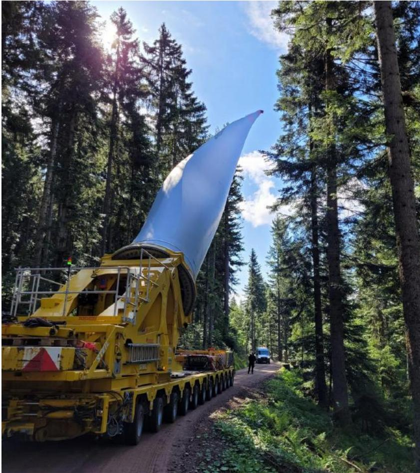
*Bild 6: Selbstfahrer beim Transport eines Rotorblattes am Windpark Hohenlochen, Ortenaukreis (Aufgenommen am 25. Mai 2022).*
